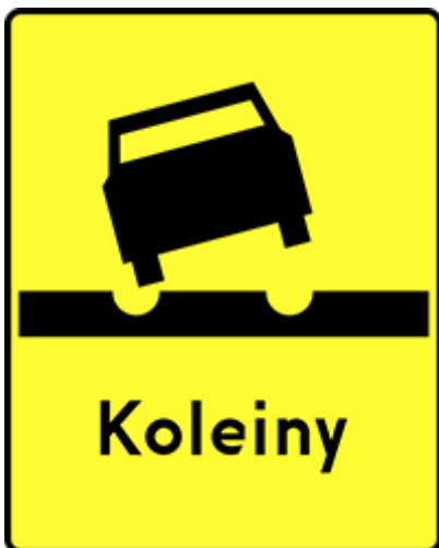
9. T-13 "Tabliczka wskazująca odcinek drogi, na którym występują deformacje nawierzchni w postaci kolein"
