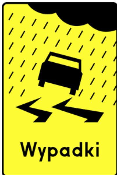
15. T-15 "Tabliczka wskazująca miejsce częstych wypadków spowodowanych śliską nawierzchnią jezdni ze względu na opady deszczu"
